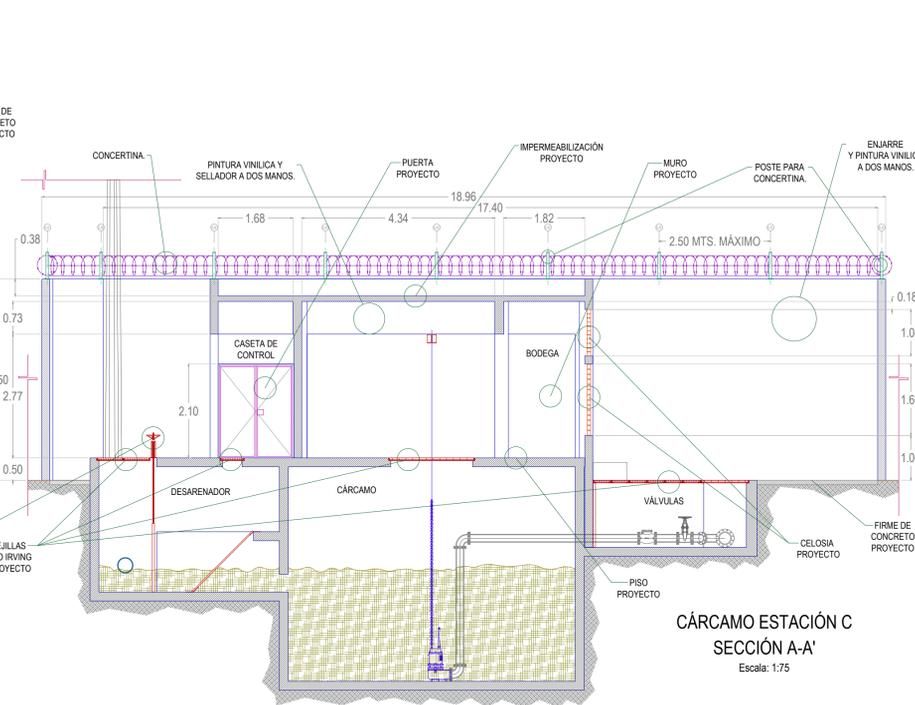
CÁRCAMO ESTACIÓN C SECCIÓN A-A'
